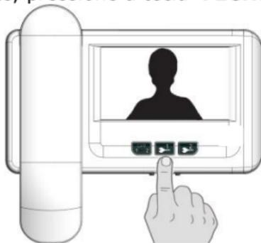
Para abrir a Fechadura da **Saída RELÉ (CONTATO SECO NA/C)** pressione a tecla **FECH2**. O tempo de acionamento desta saída é de 2 segundos.
