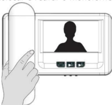
5. Para iniciar uma conversa a partir do Monitor para o Painel e visualizar a imagem, pressione a tecla **CAM1-2** para visualizar a imagem da câmera do **Painel 1**, pressione novamente a tecla **CAM1-2** para visualizar a imagem da câmera do **Painel 2** e, em seguida, retire o monofone do gancho para ligar o áudio.
