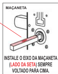
Passo 4 Instale a parte traseira da fechadura
