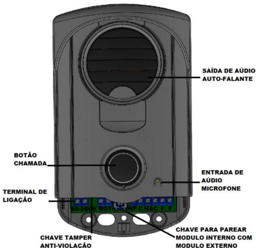
**90-260V:** Entrada de alimentação 90-260 Vac (50/60 Hz), utilize um cabo com bitola máxima de 2,5 mm<sup>2</sup>.
